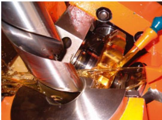
MOTOREX ORTHO NF-X, malgrado la sua grande fluidità, che raggiunge ISO 15, con la sua grandissima stabilità sa imporsi sotto alta pressione. Il raffreddamento del particolare è ottimale e l'evacuazione dei trucioli rapida, i quali non determinano una rilevante asportazione dell'olio medesimo.
