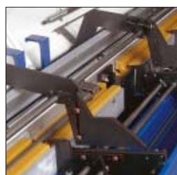
plice arresto", riducono del massimo possibile le manipolazioni superflue e accrescono la rapidità del cambio di capacità durante la messa a punto. Ne consegue che l'utilizzatore guadagna tempo prezioso.
