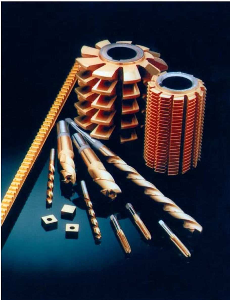
Alcuni particolari in acciaio vengono lavati esclusivamente nel solvente A3. Essi hanno una tensione di superficie superiore a 52 mN/m dopo sgrassatura e asciugatura; questa qualità è perfettamente adattata ai depositi CVD o PVD. Un controllo supplementare viene effettuato a mezzo di un foglio di carta crespata imbevuto di alcool isopropilico e strofinata sul particolare e sui fori ciechi. La pulitura è soddisfacente se nessuna impronta sulla carta è visibile al microscopio.
