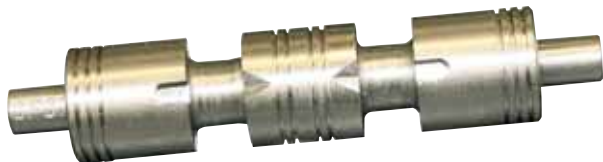
Un tipico particolare lavorato da MMT. Il numero a sinistra sulla parte cilindrica viene direttamente inciso sul tornio durante le operazioni di lavorazione.
