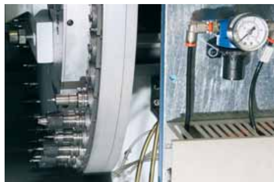
Questo magazzino degli utensili del contro-mandrino può contenere 48 utensili.
