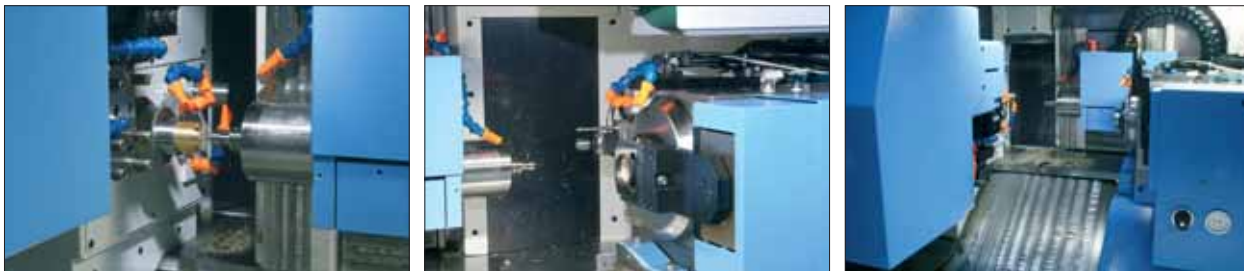
Uno sguardo sul mandrino principale: la macchina è pronta per lavorare il lato di una nuova platina direttamente sulla barra. Il contro-mandrino è in attesa di una platina per lavorare il lato due... ...che andrà a cercare direttamente sul mandrino principale.
