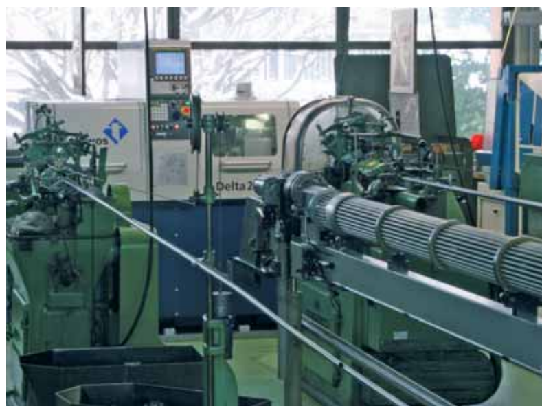
La Delta 20/5 è destinata a sostituire progressivamente i torni a camme.
