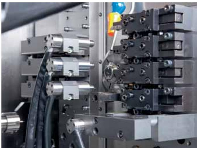
Standard sino a 80'000 giri/minuto, 120'000 in esecuzione speciale, i mandrini dell'azienda Svizzera sono molto silenziosi poiché non superano i 74 dB. (A titolo di esempio, una normale conversazione rappresenta 60 decibel e il claxon di un'automobile 100 dB. Va detto che uno scarto di 10 dB viene percepito dall'orecchio umano come un raddoppio del volume sonoro).
