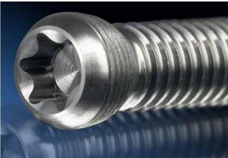
Le viti con teste Torx, sono sempre più utilizzate, in particolar modo nel medicale e ciò in virtù della loro maggiore resistenza durante il serraggio della vite. La fresatura del profilo, tramite un mandrino ad alta frequenza, sopprime le sollecitazioni connesse alla tecnologia della brocciatura (spazio per i trucioli al fondo della pre-foratura e sforzi subiti dal particolare e dalla macchina) il tutto ottenendo dei particolari di elevata e costante qualità.
