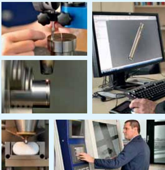
Il centro di lavorazione CU1007 è disponibile in 4 versioni di base, vale a dire 3 assi, 4 assi e 1/2, 5 assi (di cui 4 simultanei) e 5 assi simultanei. Ciò consente di scegliere la configurazione che più precisamente corrisponde ai tipi di particolari da realizzare. A ciò si aggiunga che la macchina può essere associata ad un sistema di carico e scarico dei particolari tramite un robot a 6 assi.
