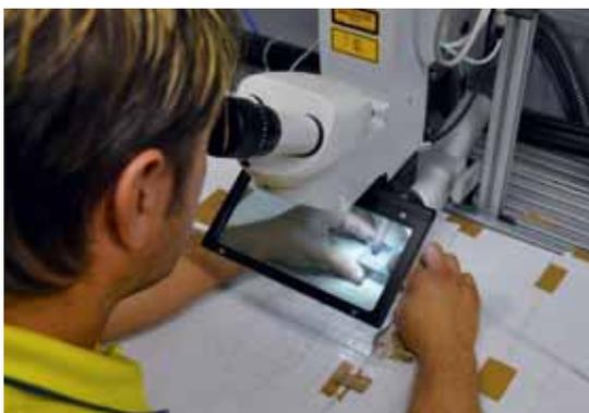
I pezzi per ganasce della pinza di pressione sono collegati ad un dispositivo di trazione tramite degli elementi articolati. Questo dispositivo è oggetto di saldatura laser sotto ingrandimento ottico.
