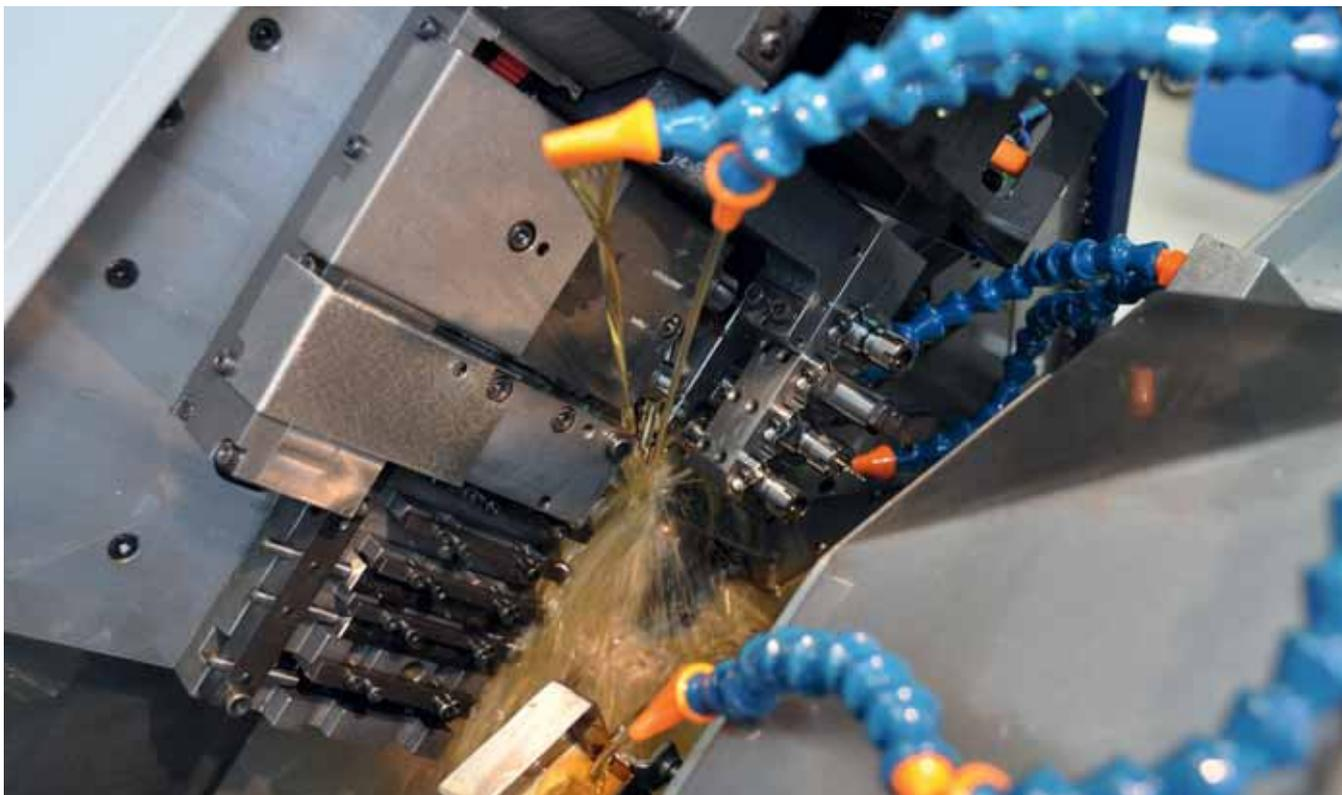
Ha la stessa importanza di un centro di lavorazione performante! Il liquido da taglio utilizzato ha un'incidenza determinante sul processo di produzione e sui costi.
