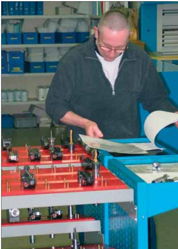
La preparazione del materiale viene fatta in precedenza: l'arresto macchine è ridotto al minimo.
