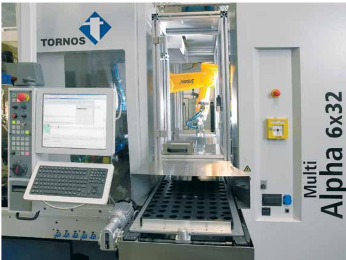
L'integrazione delle periferiche è perfettamente coerente. Nell'immagine il Robot di MultiAlpha 6x32 con il PC integrato.
