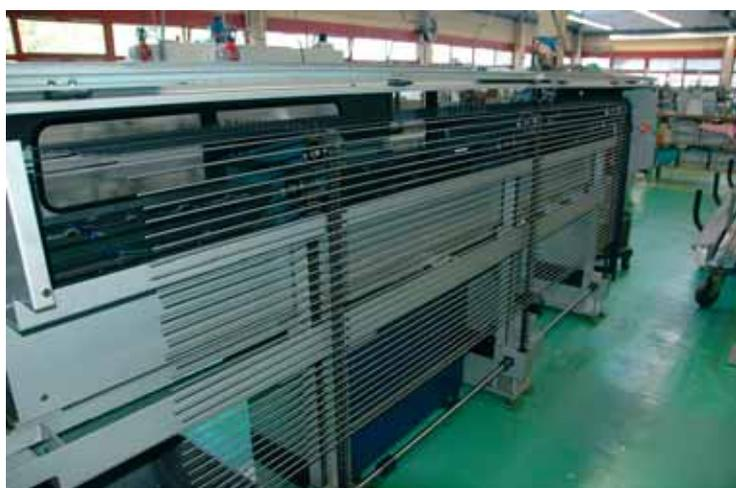
I sei mandrini vengono alimentati automaticamente dal caricatore di tipo Robobar MSF 316 tramite il quale si ottiene una produzione proficua ed illimitata anche in presenza di équipe interamente robotizzate.
