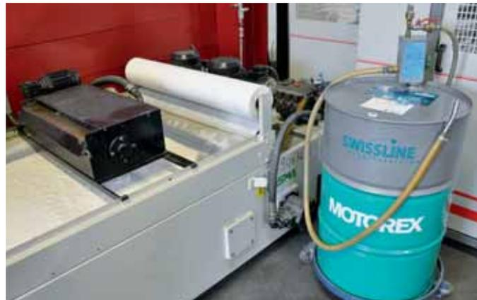
Il disoliatore a nastro raccoglie l'olio delle fughe e il filtro a nastro trattiene i più piccoli trucioli e le minuscole particelle metalliche. Sul fusto mobile di Motorex, è visibile anche il mescolatore del refrigerante-lubrificante compatto e necessario in ogni momento.
