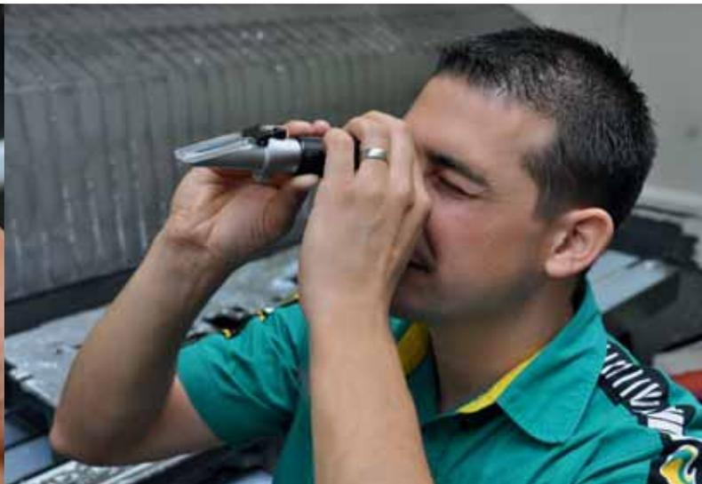
La concentrazione (proporzione di concentrato di refrigerante-lubrificante e di acqua in percentuale) può essere misurata tramite un refrattometro ottico o un apparecchio di misura elettronico, in modo semplice e preciso, e riportata nel registro della macchina.
