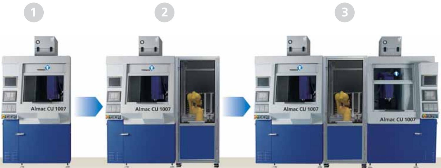
Se fosse indispensabile aumentare la produzione, l'utilizzatore può senz'altro aggiungere il sistema di palletizzazione e di robotizzazione (2), fermo restando che avrà sempre a disposizione la possibilità – immediata o successiva – di aggiungere un altro centro CU 1007 e di «condividere» il robot. (3)
