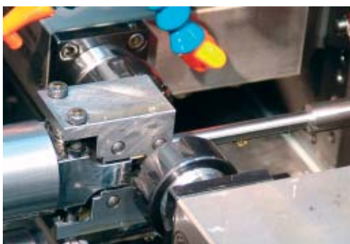
Utvändig sexkantfräsning med 2 verktyg samtidigt och support av änddetalj.
