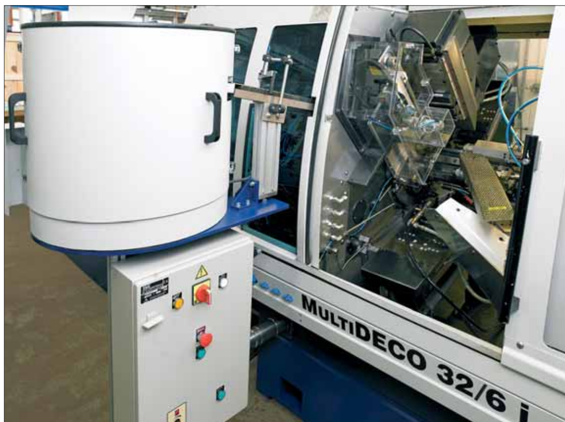
"Glid"-matningssystem tillsammans med en vibrerande skål.
