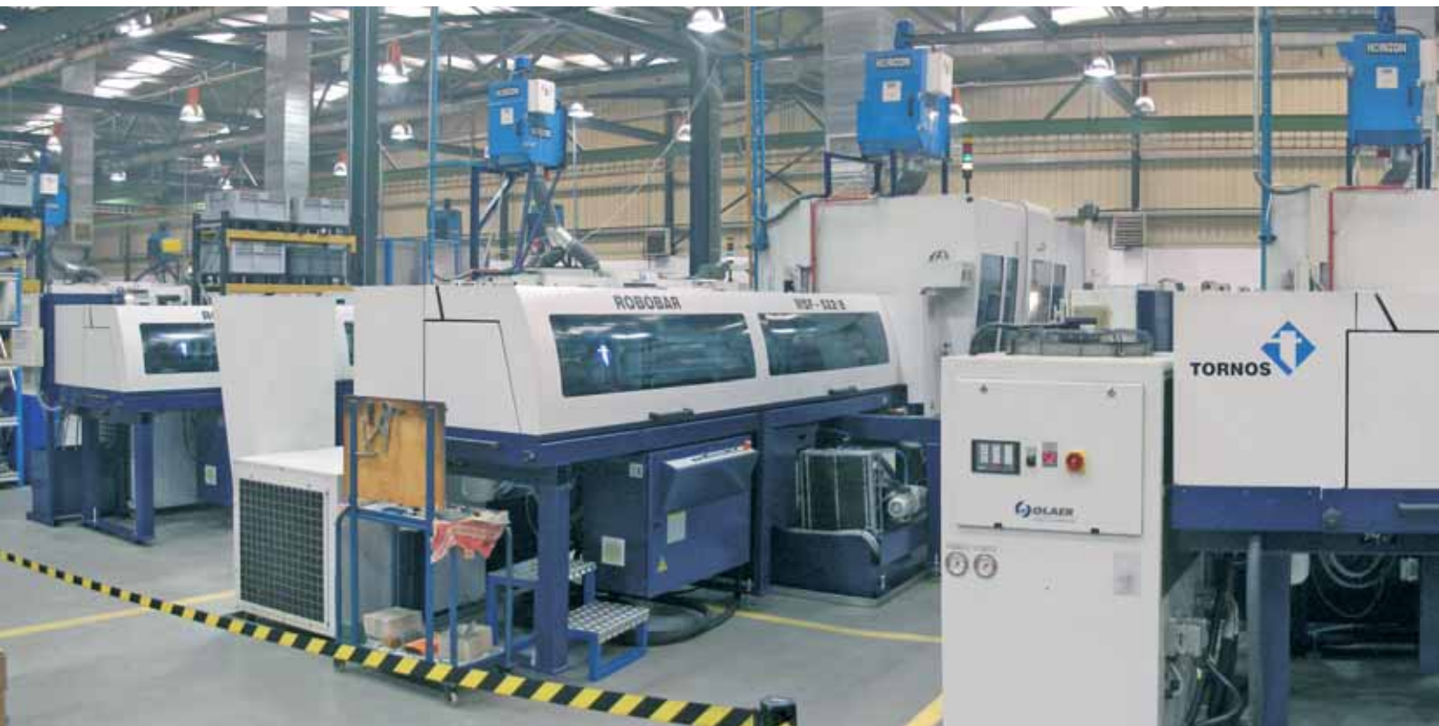
MultiAlpha- och MultiDECO-maskinerna erbjuder extraordinär potential hos Microdeco. Varje maskin är utrustad med dimutsugningsenhet för att garantera bästa möjliga arbetsförhållanden.
