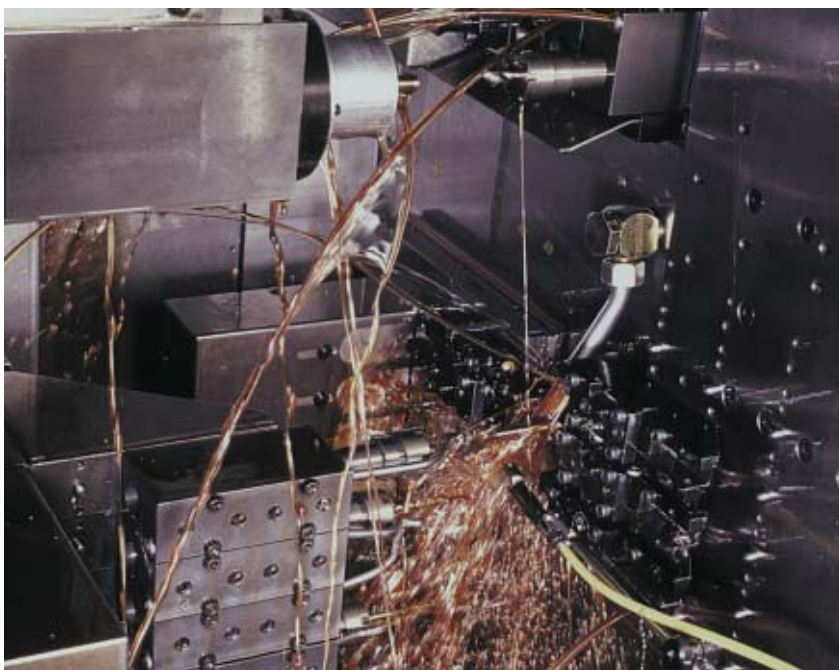
Detaljer bearbetas samtidigt på huvud- och subspindlarna i DECO 2000 och många bearbetningsoperationer utförs samtidigt, i realiteten elimineras dödtider och produktiviteten ökar.
