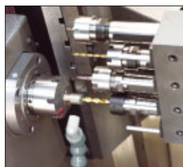
Ändbearbetning vid motspindel
