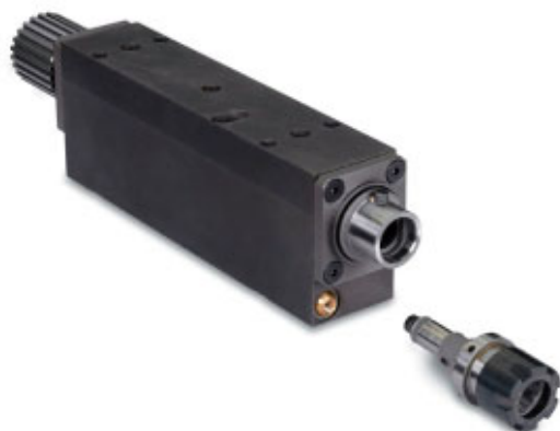
Roterande spindel för tvär- och frontoperationer vid styrbussningen och för motoperationer med demonterbart dorn som ompositioneras ultraexakt.
