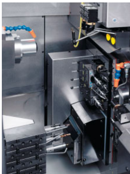
Bild på bearbetningsområdet i en svarv DECO 20a utrustad med olika snabbväxlings verktygssystem för förinställning.
