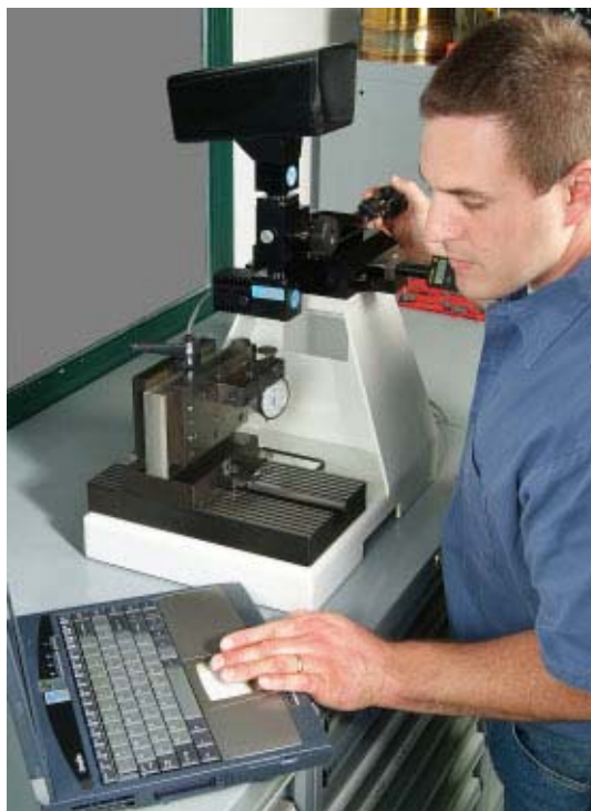
Tornos tillhandahåller en verktygsförinställningsutrustning med sina DECO-maskiner för att hjälpa till att ställa in verktyget för nästa körning medan maskinen fortfarande är i produktion.
