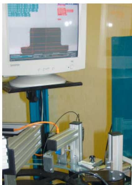
Automatisk, ultra-precis mätning av stångsvarvade komponenter baserat på ett specificerat CpK-värde. Komponenterna mäts slumpvis och jämförs mot en nominell dimensionsritning.
