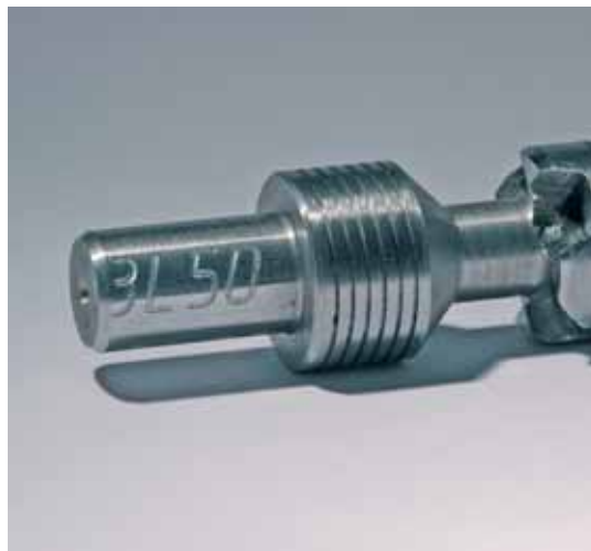
Detalj av en inskription programmerad med Millwriter och graverad när den är i svarven.
