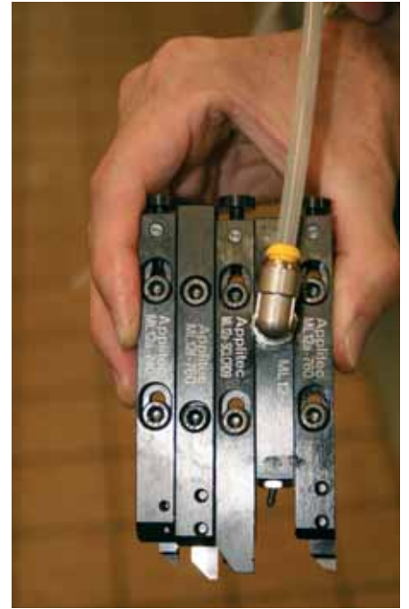
En sats verktygshållare utgör alltid ett kompakt block.
