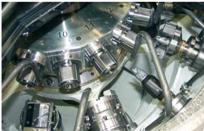
Lätt att se: På insidan av detaljhållaren vid stationerna 10 till 13 och på den motsatta sidan, en serie av olika verktyg som alla roterar under bearbetningsprocessen och som rör sig långsgående likväl som tvärgående.
