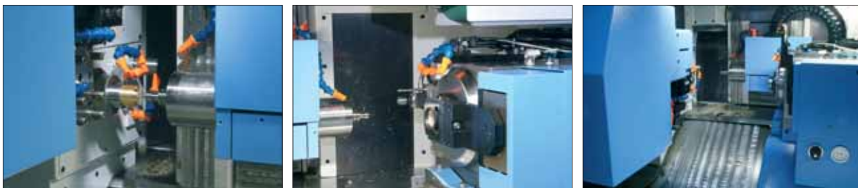
Bild på huvudspindeln: maskinen är klar att bearbeta en ny platta direkt på stängen. Motspindeln väntar på en platta att bearbeta på yta två... ...som den är direkt från huvudspindeln.
