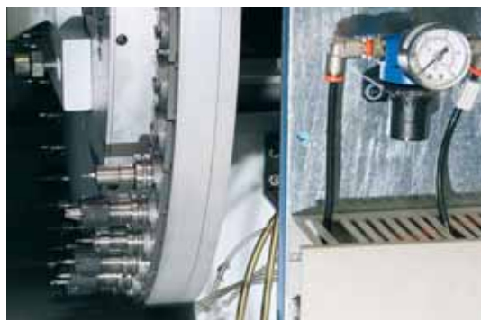
Motspindelns verktygsmagasin rymmer 48 verktyg.
