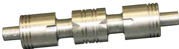
Typisk MMT-bearbetad detalj. Numret på den cylindriska delens vänstra sida är graverat av svarven under bearbetningsoperationerna.
