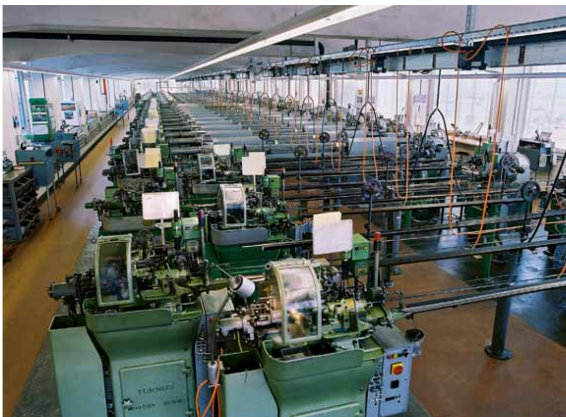
Företagets kurvstyrda maskinpark är i perfekt kondition men ledningen tänker emellertid på företagets framtid. Dessa maskiner kommer successivt att ersättas med Delta-maskiner.
