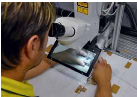
Tångens käftdelar är hopsatta via fogar med en dragdetalj. Denna är här lasersvetsad med en metalltråd under förstoring.
