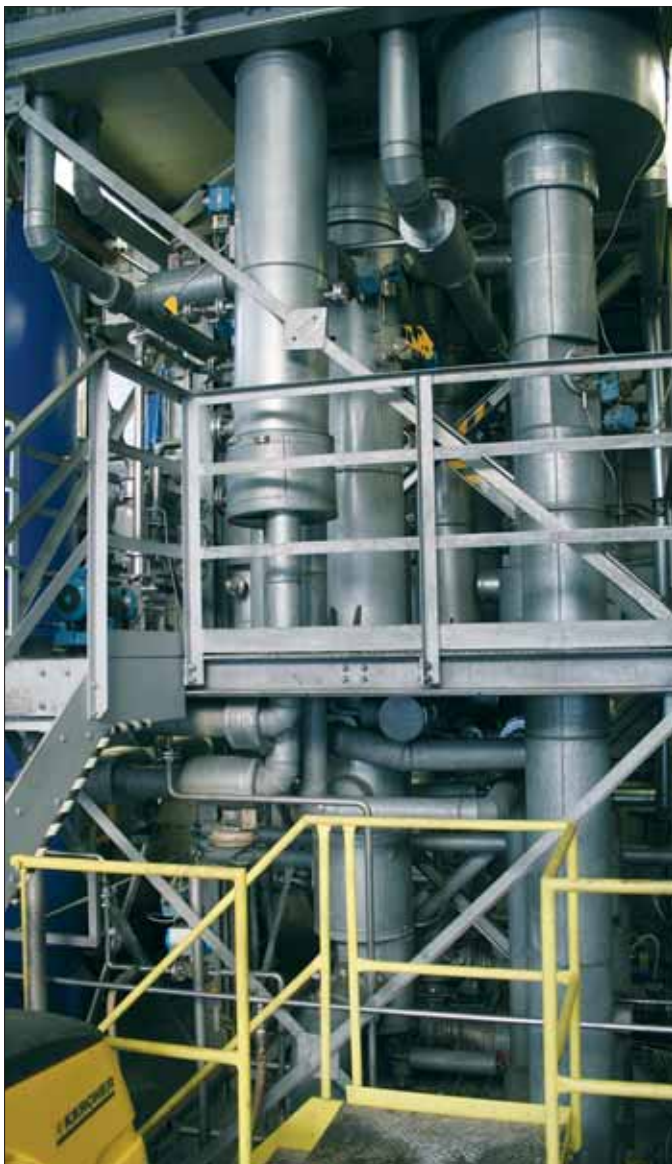
Detta är inte en vy inne i en kemisk anläggning utan den trestegs vakuump-evaporator som gör förorenat vatten till mycket rent vatten.
