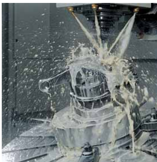
Skäremulsioner smörjer, kylvlar och avlägsnar spånor – en avsevärd arbetsbörda. (Photo: Blaser)
