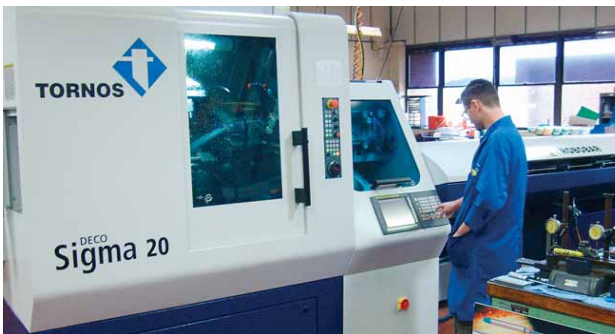
Tornos Sigma 20 hos Solartron. Maskinen har inte bara tagit tre maskiners plats utan också ökat produktiviteten med över 50%.
