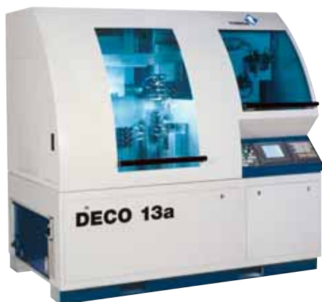
DECO 13a från Tornos, tusentals exemplar av denna maskin arbetar dag efter dag inom det medicinska området och en stor del av dem är utrustade med gängvirvlingstrustningar.
