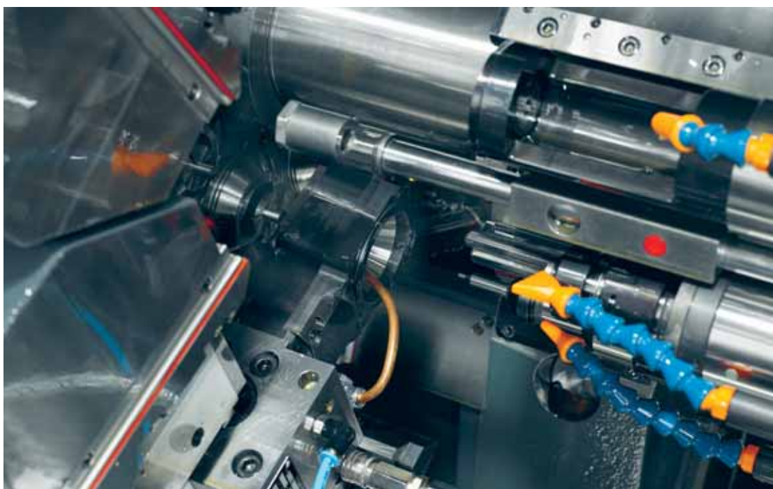
En av de två gängvirvlingsapparater som gör "halva" jobbet.
