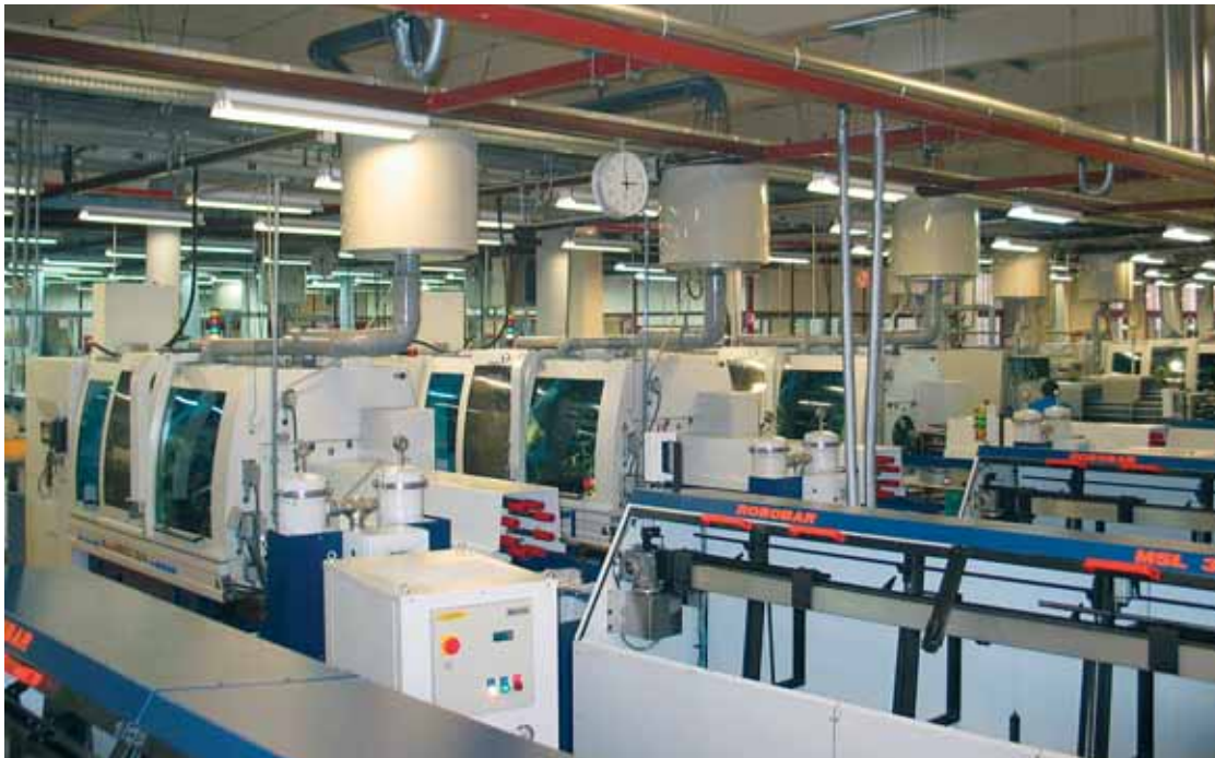
De ca tio CNC MULTIDECO-maskinerna gör det möjligt för verkstaden hos Joseph Martin SA att köra produktioner på 30 till 50 000 komponenter på det mest rationella sättet.
