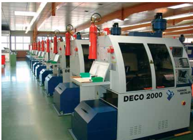
Hos MGB har alla maskiner all utrustning för säker produktion, till exempel brandskyddsutrustning.
