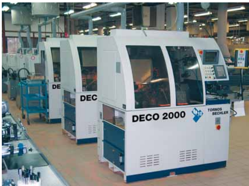
DECO-verkstden. I stil med de flerspindliga enheterna, varje maskin är förbunden med ett centraliserat luftreningsystem.
