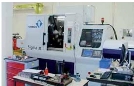
Tornos-maskinen Sigma 32 är permanent länkad till mättnings- och övervakningsenheter så att alla operationer undersöks noggrant i detalj.
