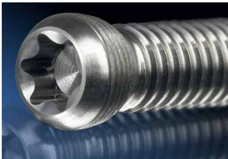
Skrubar med Torx-huvuden används allt oftare, exempelvis inom medicalsektorn, tack vare det stora skruvmotstånd. Fräsning av formen med en HF-spindel upphäver eventuella restriktioner som förknippas med brotschningsteknologin (utrymme för spånar i botten av förhålet och att detaljen och maskinen exempelvis måste hålla) och tillhandahålla högkvalitetsdetaljer med beständighet.
