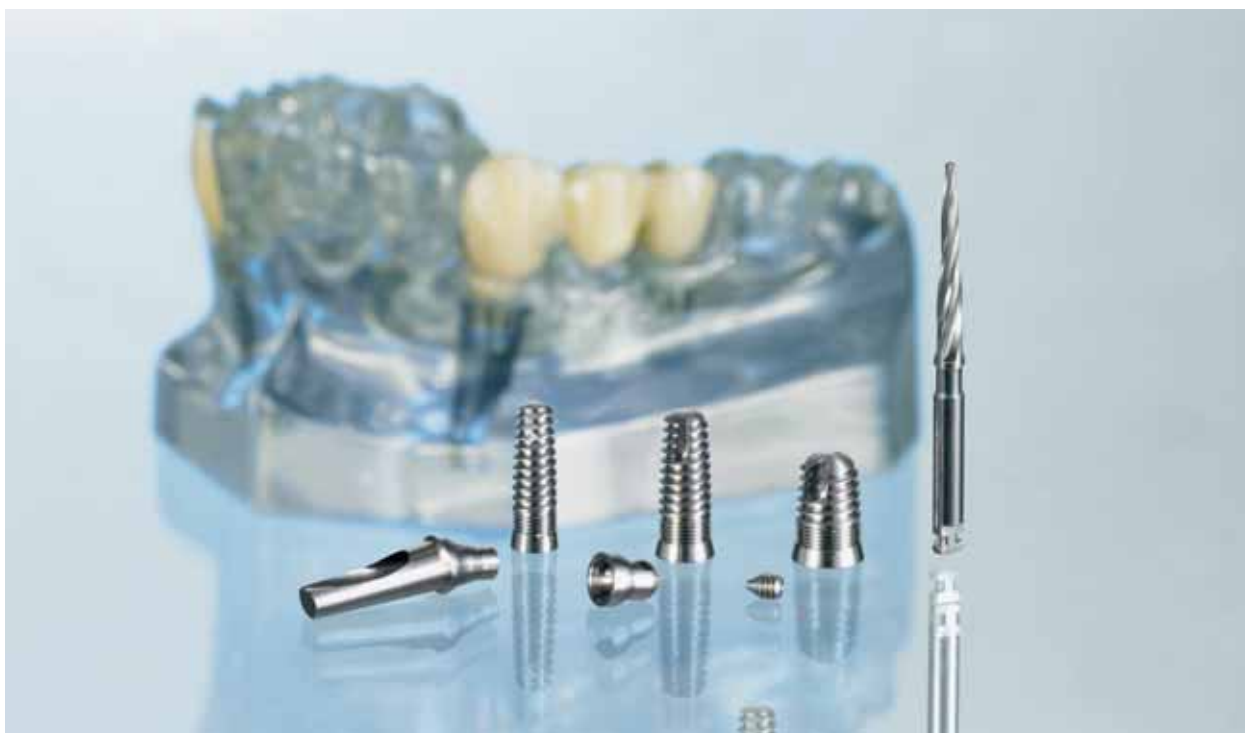
Dental-medicinaltekniska detaljer från UND från vänster: post och skruv för dentalimplantat i titan 6 V, gängade förankringar för dentalimplantat i rostfritt stål 316 L och en smidd borrar i rostfritt stål 420 F.
