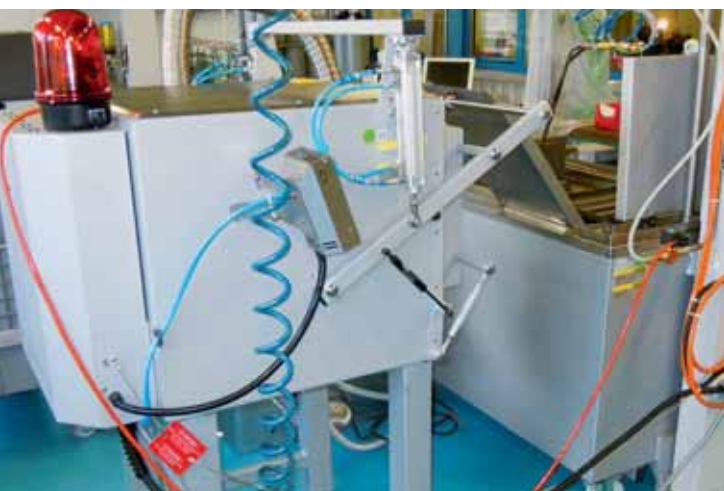
En härdningsinstallation gör små körningar av hylsor möjliga att produceras med optimerad utnyttjade resurser.
