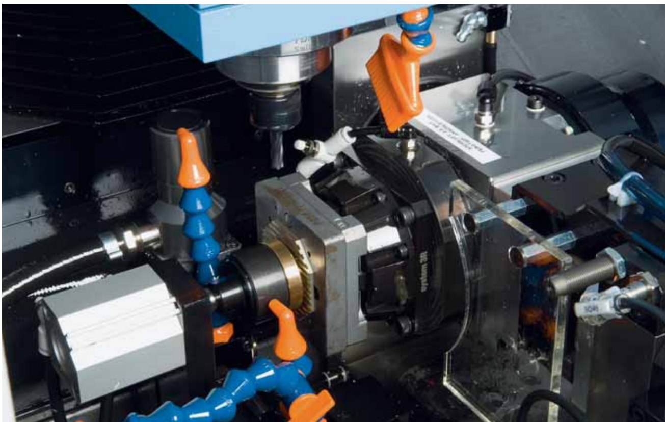
4-axlig delare med vertikal/horisontell skala: en annan egenskap hos Almacs automatisering.
