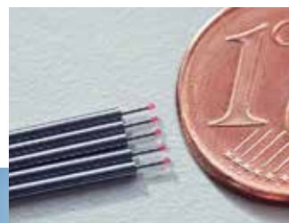
Der kleinste Messtaster hat eine Tastkugel mit einem Durchmesser von nur 0,5 mm an der Spitze. Diese wurde eingebohrt und auf den lediglich 0,17 mm feinen Schaft montiert. Hier ist höchste Präzision gefragt.
