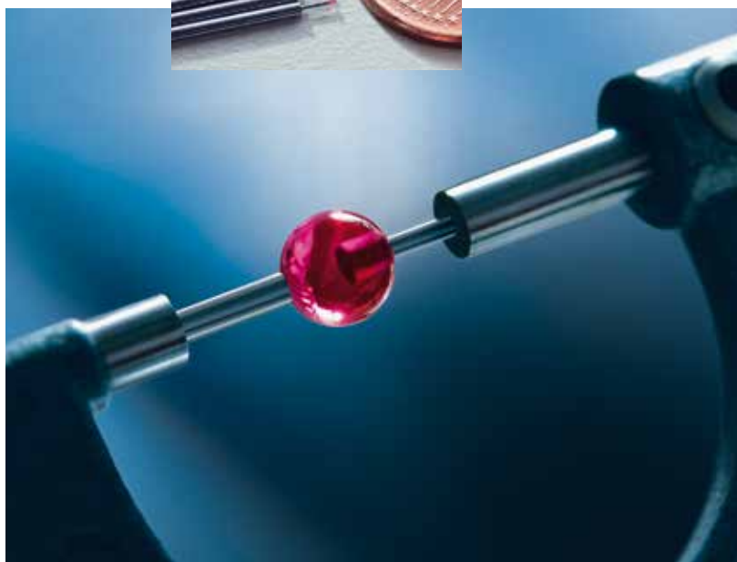
Die gezeigte Tastkugel aus Rubin hat eine extrem hohe Rundheit des Grade 5, was 0,08 bis 0,13 µ entspricht. Das Bohren der Sacklöcher für die Aufnahme der Kugel ist eine Spezialität der itp und erfordert viel Wissen und Können.
