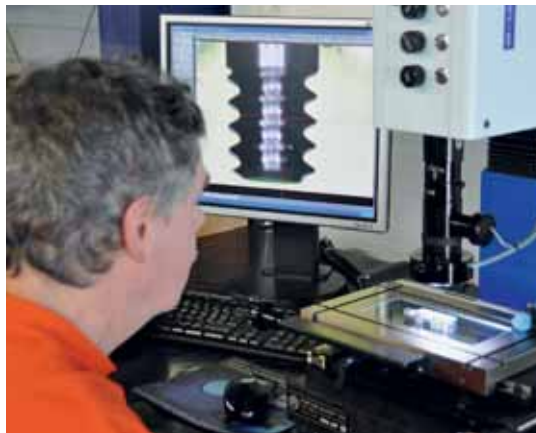
La technique de mesure innovante permet de procéder à une mesure optique des pièces, les valeurs ainsi obtenues étant analysées par le système de contrôle qualité avec le logiciel QuickControlPro®.
