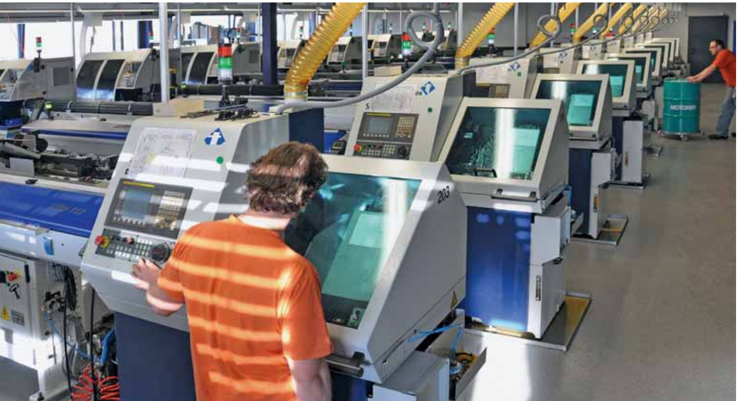
Un nombre impressionnant de machines de décolletage CNC de Tornos, ici au premier étage, assurent la fabrication des pièces 24h/24.
