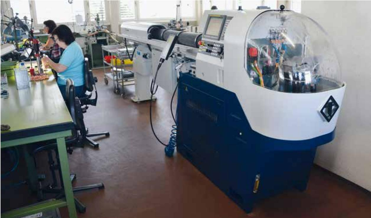
Pour les besoins du test, la machine SwissNano a été installée en dehors de l'atelier de décolletage. Son encombrement réduit et son concept lui permettent de trouver sa place dans tout atelier. Comme il n'y a aucun accès à l'arrière, elle peut même être placée contre un mur.
