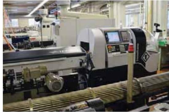
Die Swissnano und der lemca-Stangenlader benötigen besonders wenig Platz. Der Geschäftsleiter plant, Maschinen mit 2 Meter-Stangenförderern aufzustellen, um die Anzahl der installierten Maschinen zu erhöhen.
