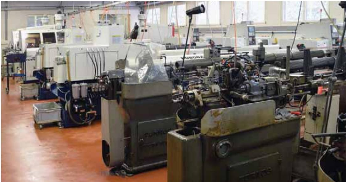
In der Werkstatt von Ultra stehen zahlreiche unterschiedliche Maschinen, deshalb haben sie für jedes Werkstück das richtige Produktionsmittel. Bei Produktionsläufen unter einer Woche ersetzt die SwissNano heute die kurvengesteuerten Maschinen.
