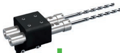
Embase à 2 alésages pour porte-forets destinés au perçage profond. Montage sur le chariot de la contre-broche. Longueur de perçage maximum: 160 mm. Présence d'un raccord pour le liquide de coupe haute pression.
